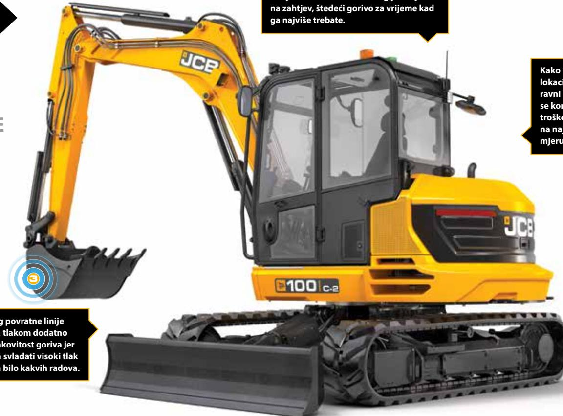
Hidraulika osjetljiva na opterećenje na strojevima Dash 2 troši energiju isključivo na zahtjev, štedeći gorivo za vrijeme kad ga najviše trebate.
